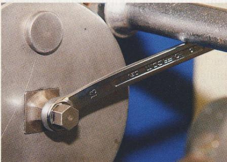
Der Facom verformte sich ab 209 Nm minimal, hielt dann aber bis zum Drehmomentmaximum durch
