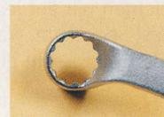
**Sollwerte nach DIN 3113: Maßhaltigkeit Maul und Ring:** 13,40 mm bis 13,24 mm, **Drehmoment Maul:** mindestens 51 Nm, **Ring:** mindestens 107 Nm. **Maximale Anzugsmomente für M8-Schrauben (Schlüsselweite 13 mm):** 25 Nm (Güte 8.8), 34 Nm (Güte 10.9) 43 Nm (Güte 12.9)
