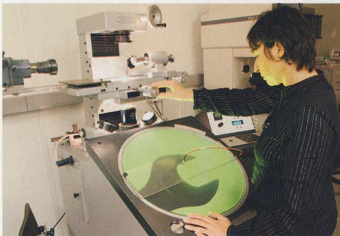
Entsprechen die Maße von Ring und Maul der DIN? Bei der Forschungsgemeinschaft Werkzeug und Werkstoffe e.V. in Remscheid misst Emine Pistor die Schlüsselweite mit einem aufwendigen Projektionsgerät auf vier Hundertstel Millimeter genau. Nur die Schlüssel von Ajay, HR und Müller erwiesen sich in dieser Disziplin als grenzwertig
