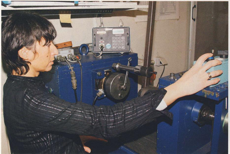
Nach dem Einrichten des Drehmomentprüfstandes zieht sich Emine Pistor sicherheitshalber hinter eine Plexiglasscheibe zurück – falls doch einmal ein Schlüssel plötzlich brechen sollte
